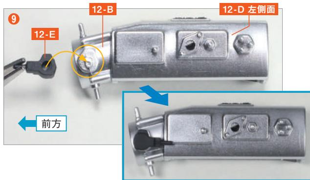
將節氣門位置感測器 12-E 的突起形狀與 12-B 的洞孔形狀對準並插入。
