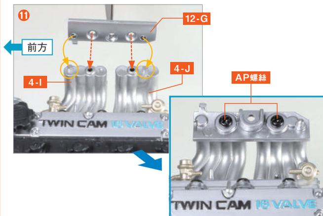
將引擎正面朝左邊。將進氣歧管 (L) 4-I 和進氣歧管 (R) 4-J 的突起部分對準「T-VIS」緩衝罐 (2) 12-G 上的4個凹槽，並使用 AP 螺絲 固定兩個位置。
