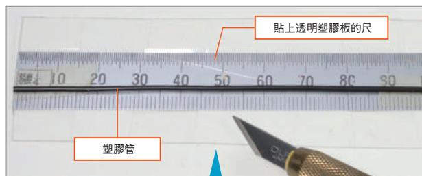
在 step4 中，將會把塑膠管切割出連接的配線。使用左側的尺，或者製作如下方照片所示的工具，同時使用刀片或剪刀進行切割，並且測量長度以確保切齊。
