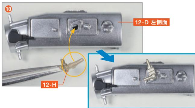
將 12-D 的左側面的洞孔形狀與冷起動噴油器 12-H 的突起形狀對準並插入。
