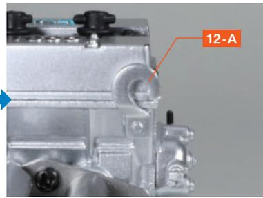
備妥已經組裝完成到第11期的引擎，如同照片的方向放置。將汽缸頭 3-G 左側面的洞孔，與懸掛鉤 12-A 的突起形狀對準插入。
