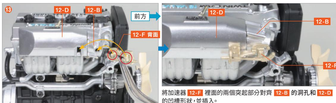
將加速器 12-F 裡面的兩個突起部分對齊 12-B 的洞孔和 12-D 的凹槽形狀，並插入。
