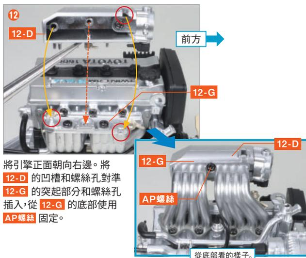
將引擎正面朝右邊。將 12-D 的凹槽和螺絲孔對準 12-G 的突起部分和螺絲孔 插入，從 12-G 的底部使用 AP 螺絲 固定。
